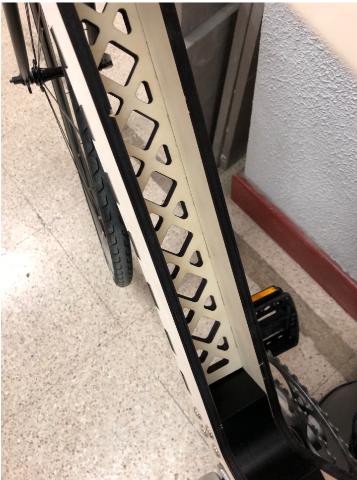
Figura 77. Refuerzo estructural inferior prototipo evo6. Fuente: (elaboración propia)
