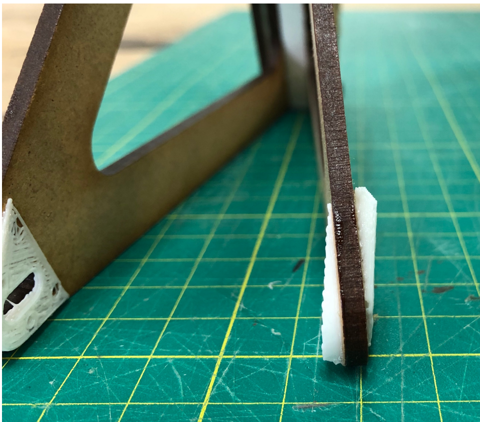
Figura 52. Punteras traseras evo2 impresas en 3D. Fuente: (elaboración propia)
