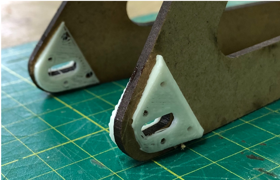
Figura 51. Punteras traseras evo2 impresas en 3D. Fuente: (elaboración propia)
