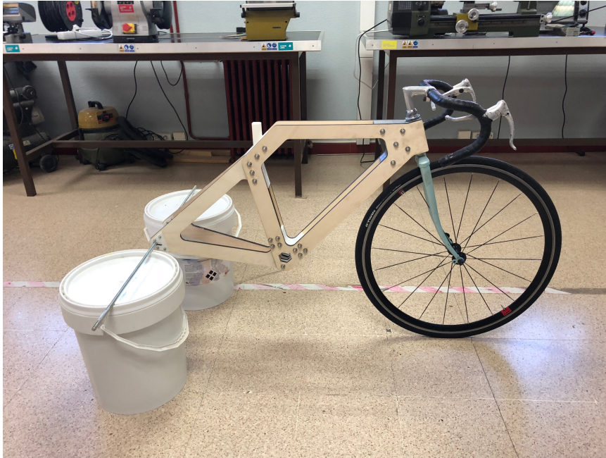
Figura 64. Prueba en estático del prototipo evo2. Fuente: (elaboración propia)
