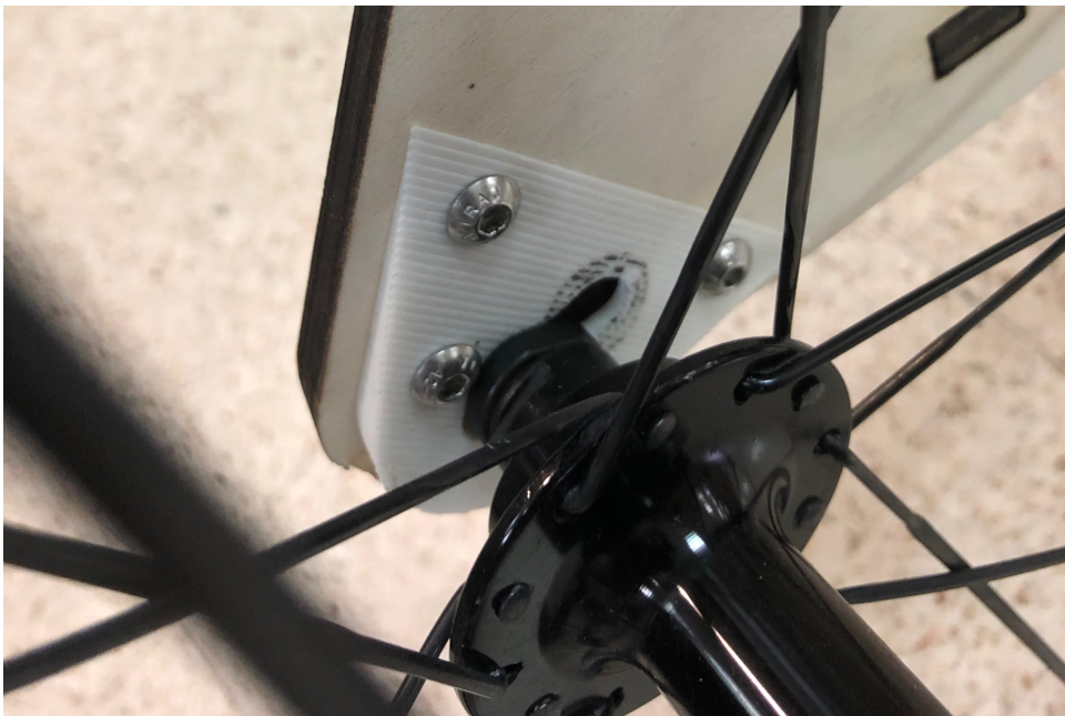
Figura 72. Pieza de acople modificada de la rueda trasera en el prototipo evo4. Fuente: (elaboración propia)
