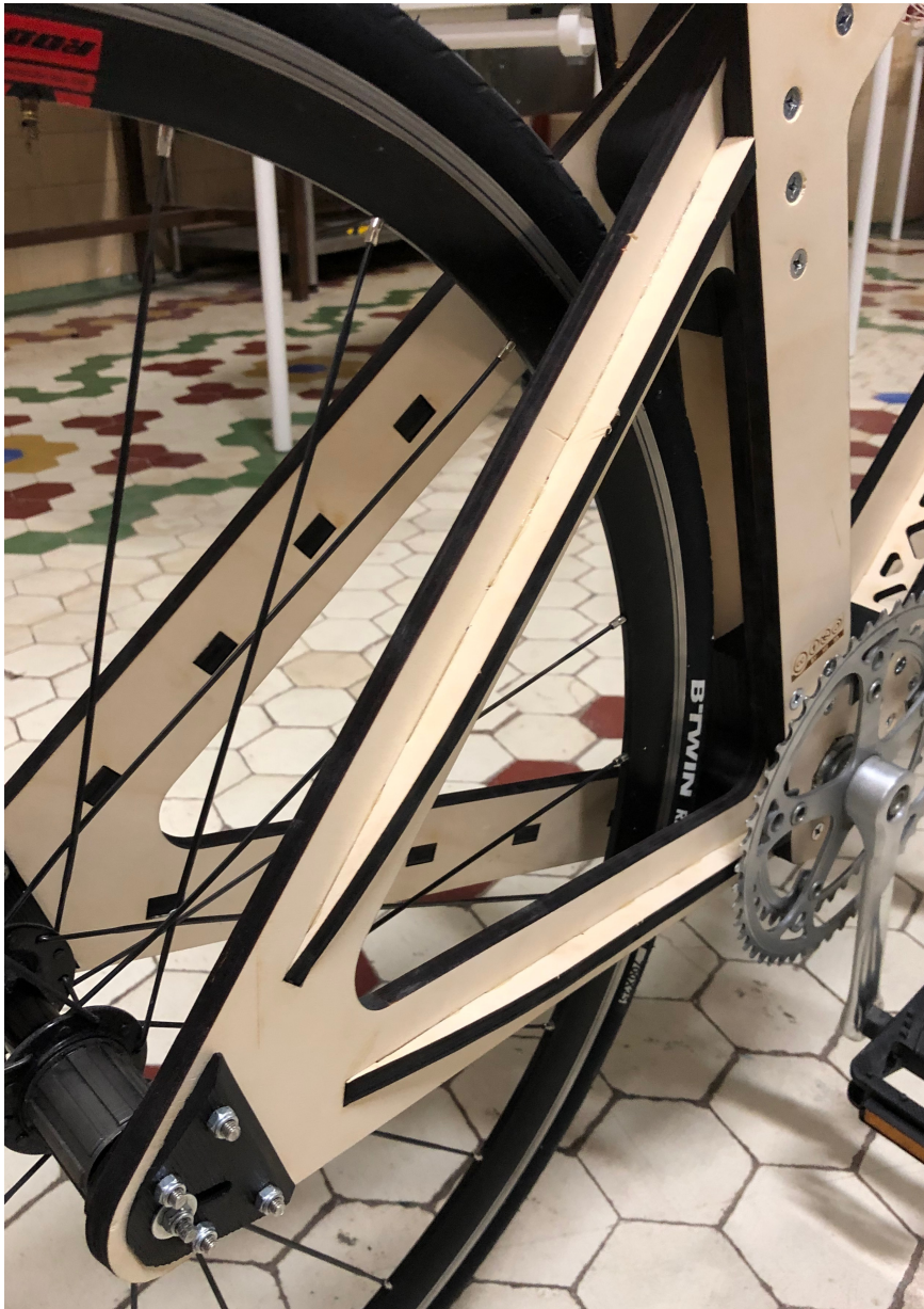
Figura 83. Vainas reforzadas con nervios de refuerzo. Fuente: (elaboración propia)
