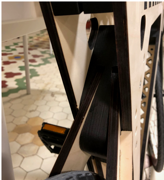
Figura 80. Pieza central de la bicicleta impresa en 3D con refuerzos añadidos. Fuente: (elaboración propia)
