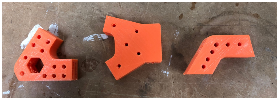
Figura 47. Piezas impresas en 3D, material PLA, que sirven de unión de las láminas. Fuente: (elaboración propia)
