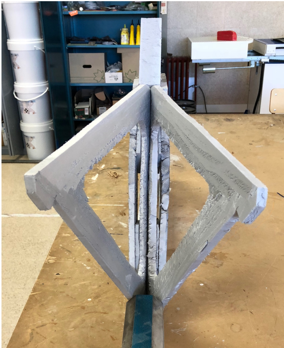
Figura 34. Detalle del cajeadado y ángulo de apertura en las vainas traseras. Fuente: (elaboración propia)
