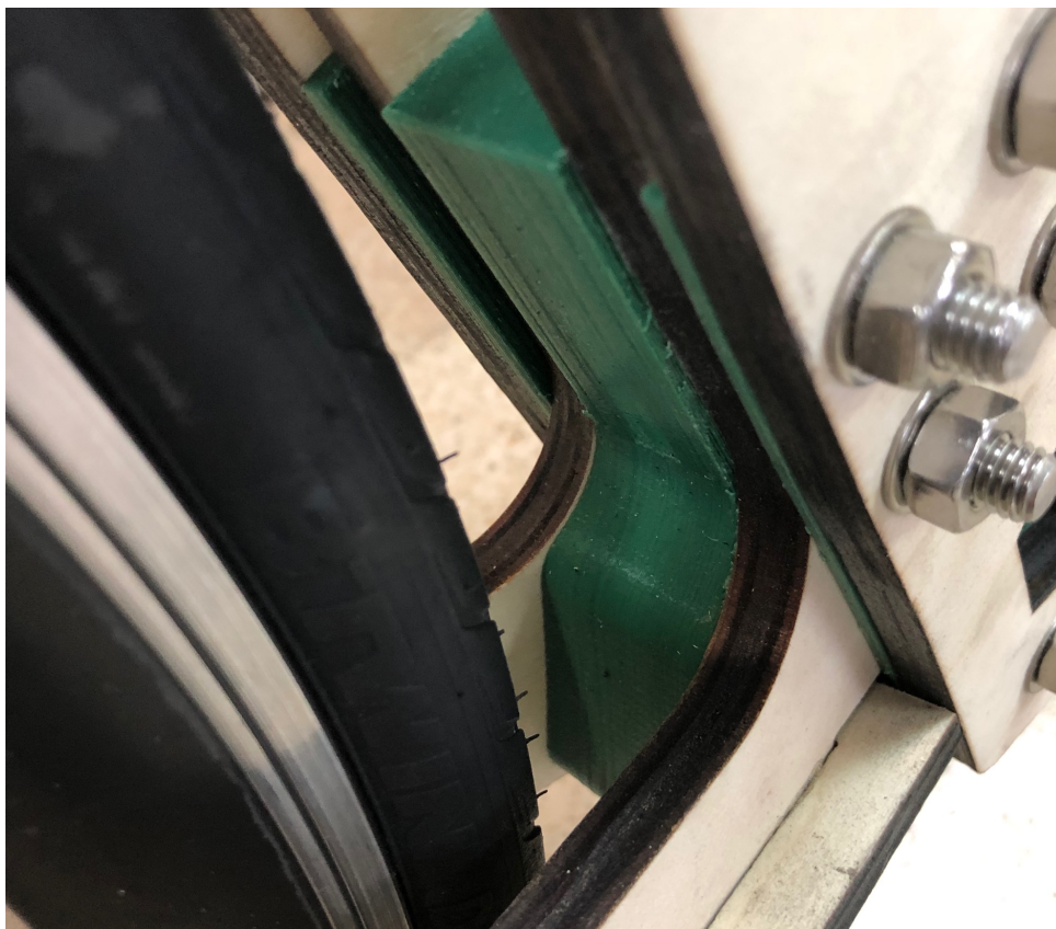
Figura 69. Refuerzo en la pieza inferior en el prototipo evo4. Fuente: (elaboración propia)
