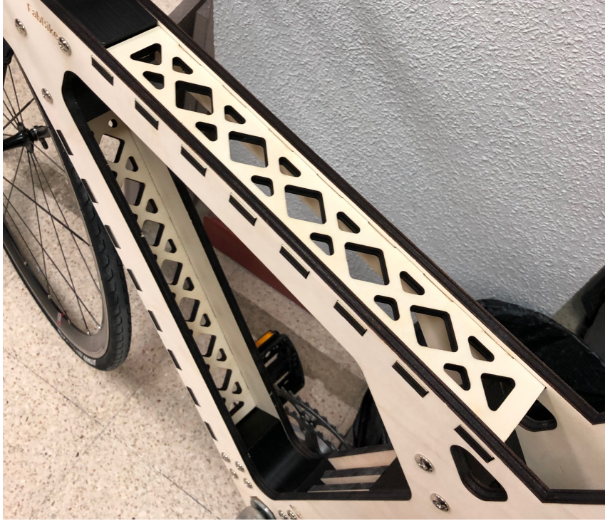
Figura 76. Refuerzos estructurales y tercer triángulo prototipo evo6. Fuente: (elaboración propia)
