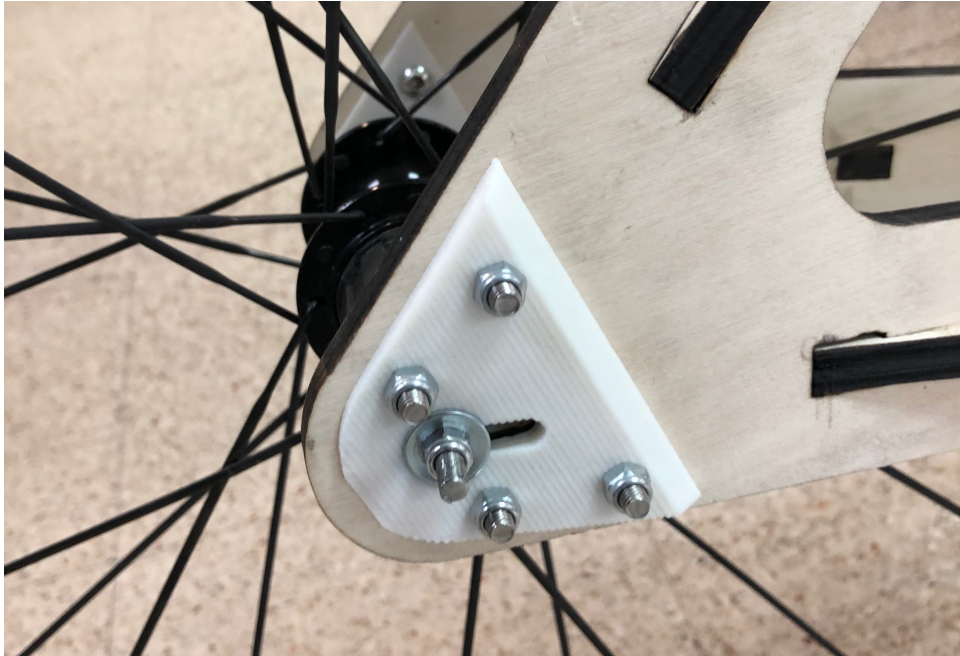
Figura 71. Pieza de acople modificada de la rueda trasera en el prototipo evo4. Fuente: (elaboración propia)
