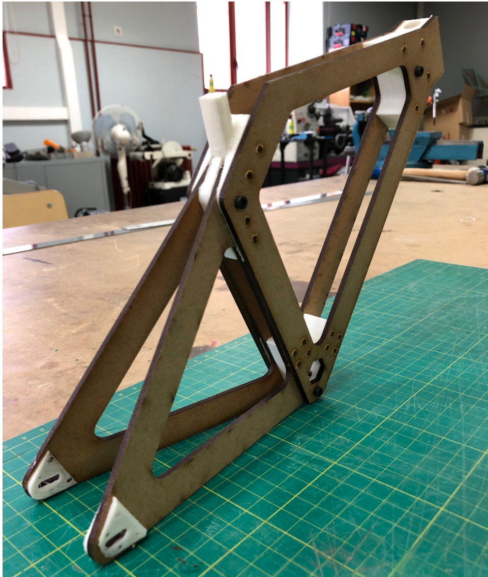
Figura 53. Maqueta evo2 escala 1:3,33. Fuente: (elaboración propia)
