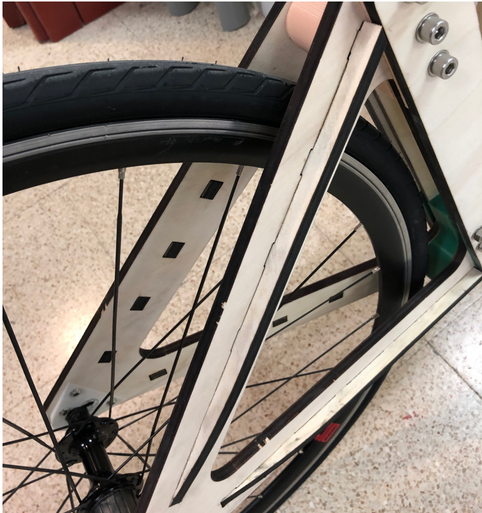
Figura 70. Nervios de refuerzo en las vainas en el prototipo evo4. Fuente: (elaboración propia)
