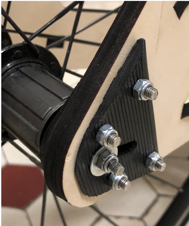
Figura 84. Piezas para el centrado del buje trasero. Fuente: (elaboración propia)
