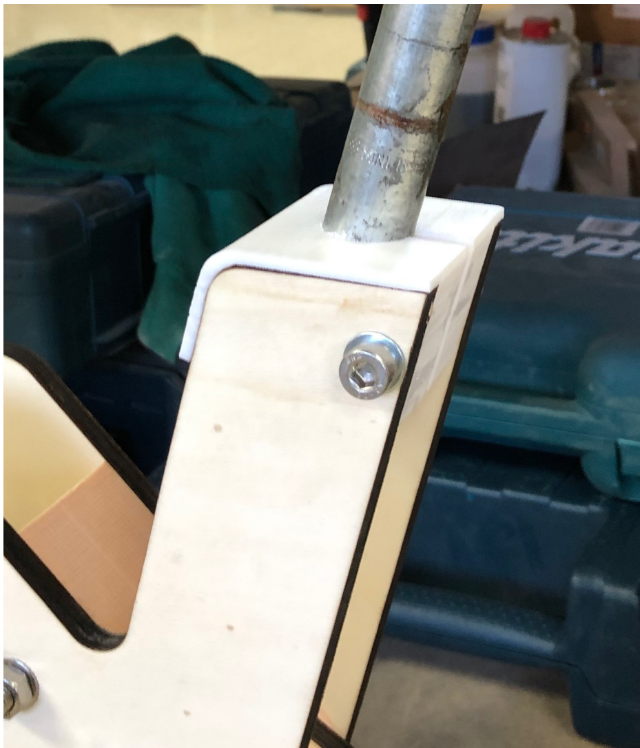
Figura 73. Diseño y soporte para el sillín impreso en 3D. Fuente: (elaboración propia)
