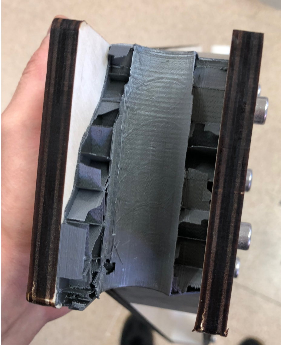
Figura 66. Fractura de la pieza delantera durante la prueba en estático. Fuente: (elaboración propia)
