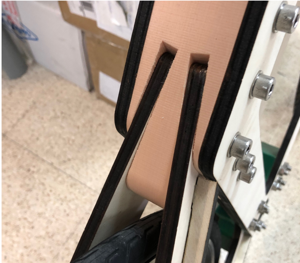
Figura 68. Refuerzo en la pieza central en el prototipo evo4. Fuente: (elaboración propia)
