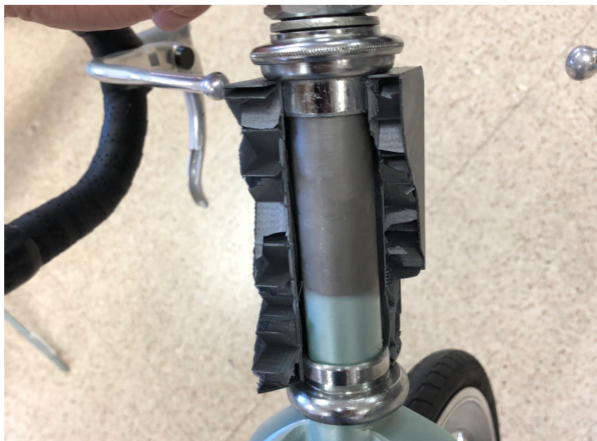
Figura 65. Fractura de la pieza delantera durante la prueba en estático. Fuente: (elaboración propia)
