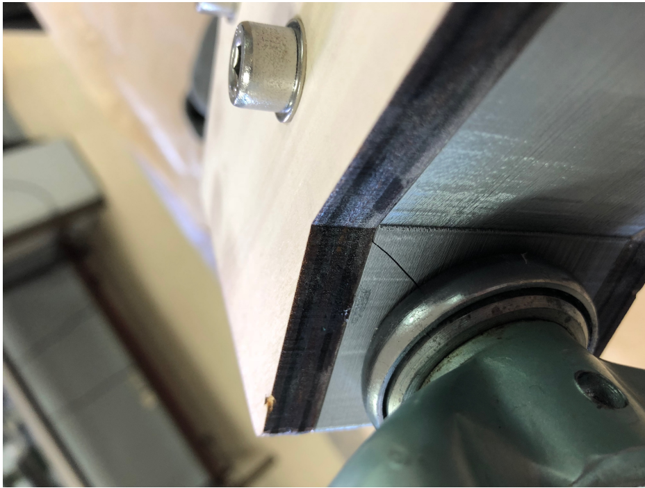
Figura 62. Fractura en la pieza delantera impresa en 3D. Fuente: (elaboración propia)
